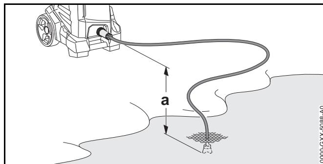
Damit das Wasser angesaugt werden kann, darf der Höhenunterschied zwischen dem Hochdruckreiniger und der Wasserquelle die maximale Saughöhe (a) nicht überschreiten, 19.1.
