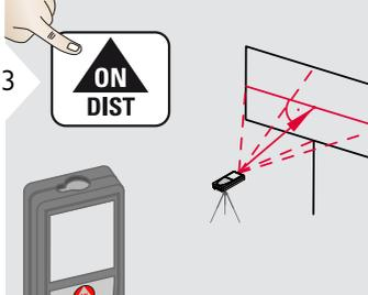
**Lotrecht auf die horizontale Mittellinie der Fläche zielen. Diese Fläche muss absolut eben auf der vertikalen Ebene liegen.**
