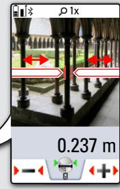
Pfeile auswählen mit den Cursortasten oder durch Antippen des Displays. Dann Pfeile verschieben durch Softkeys. Der entsprechende Durchmesser wird berechnet.
