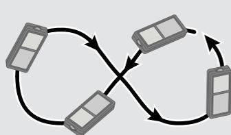
Gerät langsam in Form einer 8 drehen, bis Symbol OK angezeigt wird.
