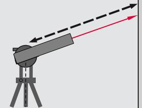
Die Distanz wird dauerhaft ausgehend vom Stativgewinde ermittelt.
