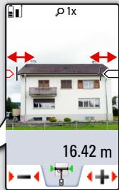
Pfeile auswählen mit den Cursortasten oder durch Antippen des Displays. Dann Pfeile verschieben durch Softkeys. Die entsprechende Breite wird berechnet.
