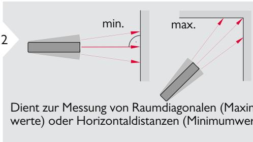
Die gemessene Minimum- und Maximumdistanz wird angezeigt (min, max). Der zuletzt gemessene Wert wird in der Hauptzeile angezeigt.
