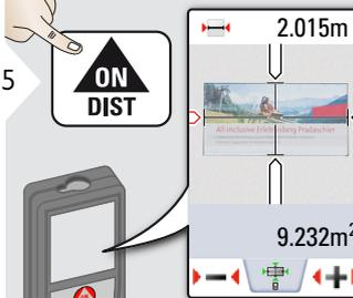
Pfeile auswählen mit den Cursortasten oder durch Antippen des Displays. Dann Pfeile verschieben durch Softkeys. Die entsprechende Fläche wird berechnet.
