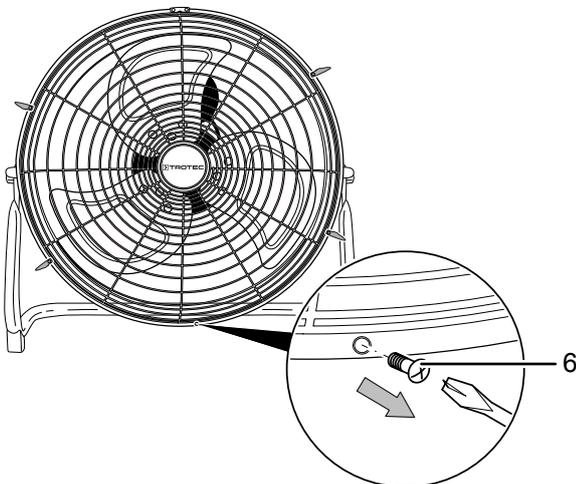
3. Um das Schutzgitter nach der Reinigung wieder am Ventilator zu befestigen, bringen Sie die Verbindungsschraube (6) an und schließen Sie die vier Befestigungsklammern wieder.
