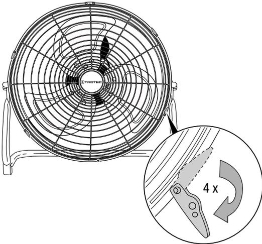
2. Lösen Sie die Verbindungsschraube (6) unterhalb des Schutzgitters (1).
